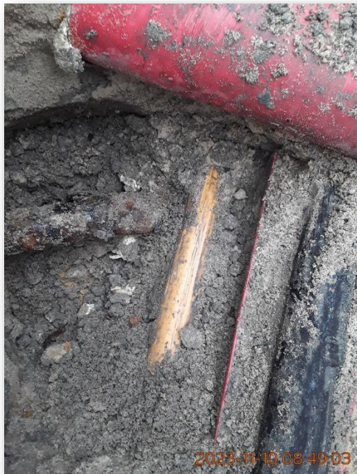
Uszkodzenie kabla 15kV przy wykonywaniu przewiertu dla przedsiębiorstwa z branży gazowniczej
